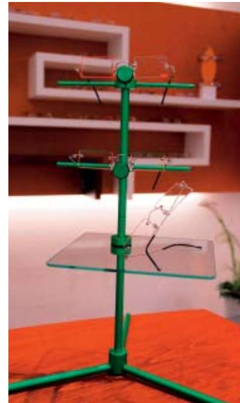
Basis des Präsenters ist entweder ein Fußsockel, der aus Buche bestehen kann, oder ein Aluelement. Die Aluelemente, Gewindebuchsen und Stäbe sind in acht Farben zu haben. Aufgebaut wird in beliebiger Höhe, kinderleicht und mit wenigen Drehungen.
